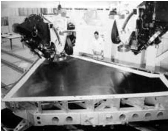
Nouveaux matériaux : nappage des composites à l'usine Dassault à Biarritz (L'Art de l'ingénieur, expo CGP, Paris 1997)
