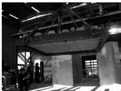
Figure 1. construction en blocs de pierre Ecole d'Architecture de Paris-Malaquais
